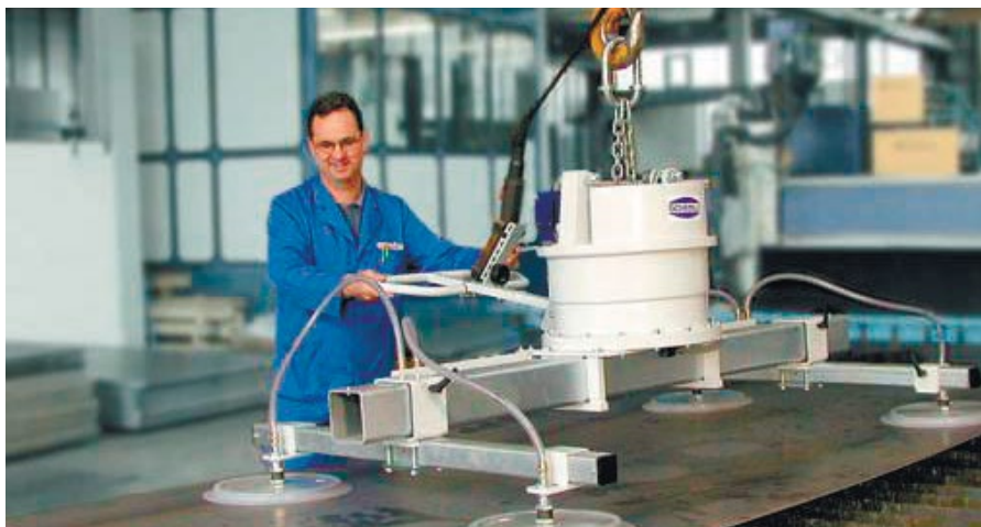
Рис. 2. — Использование вакуумного подъемника для загрузки листов на рабочий стол машины для термической резки листа.
