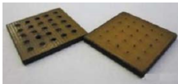
Рис. 2. Технологические пробы деталей из титанакса, изготовленные резкой лазером.
